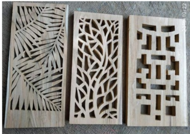
Gambar 1. Stilasi ornamen ukiran bergaya oriental untuk sandaran kursi rotan dengan konstruksi knockdown system dengan proses masinal (CNC Router). (Desain: Eddy Supriyatna, 2019)
