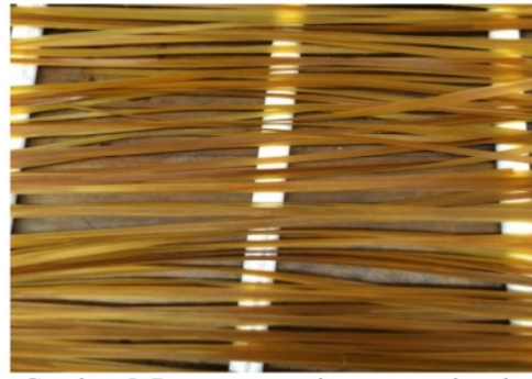
Gambar 5. Proses pengeringan serat bambu pada temperatur ruang
