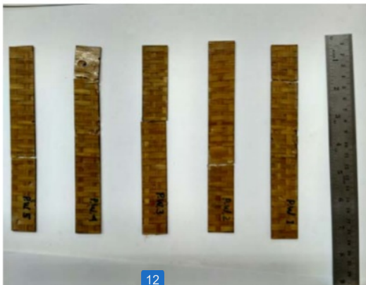
Gambar 10. Spesimen hasil uji tarik anyaman plain
