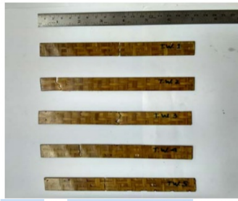
Gambar 11. Spesimen hasil uji tarik anyaman twill
