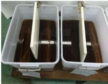
Gambar 4. Proses perendaman dengan NaOH 5% selama 72 jam
