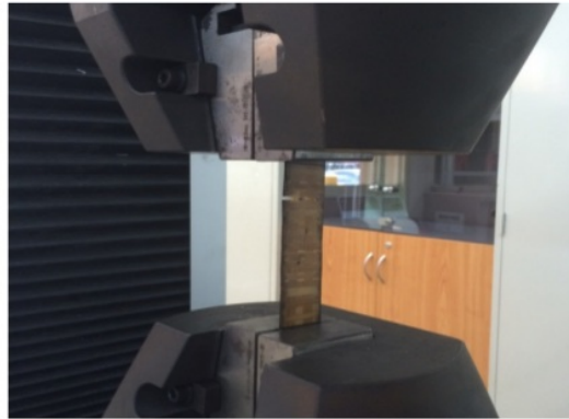
Gambar 9. Proses uji tarik komposit
