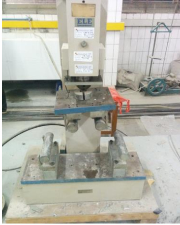
Gambar 1. Mesin uji lentur ADR 3000
