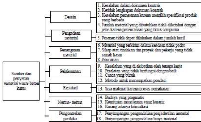
Gambar L-2. Sumber dan penyebab material waste beton kasar
