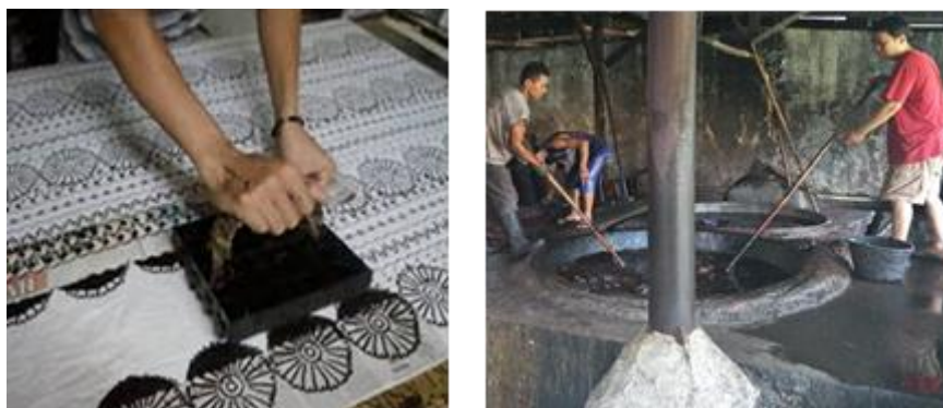
Gambar 1.1. Salah satu alat tradisional yang digunakan Batik 20 Ikan Mas Pada Gambar 1.1. terlihat alat tradisional yang digunakan Batik 20 Ikan Mas untuk mencetak. Setelah dicetak baru dilakukan pencelupan sesuai warna pesananan pelanggan.
