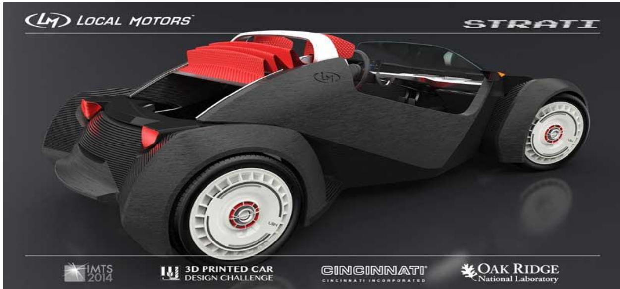
Gambar.7 Mobil yang dirakit dengan 3D printing
