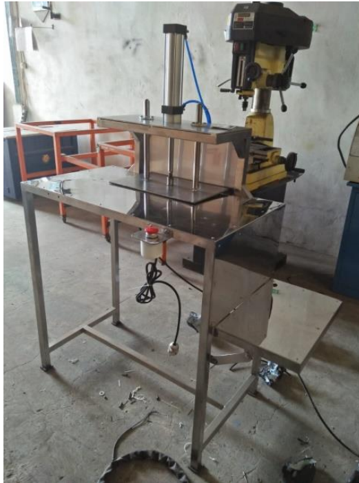
Gambar 7. Alat Bantu Pengecekan Angin Produk Container DRI II
