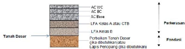
Gambar 1. Tipikal Susunan Lapis Perkerasan Lentur
