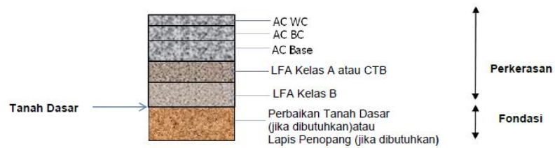
Gambar 1. Tipikal Susunan Lapis Perkerasan Lentur
