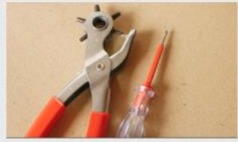
Alat pelubang engsel dan obeng untuk membuat lubang pemasang bilah bambu
