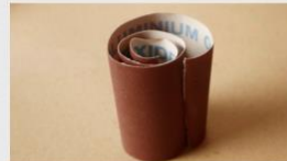
Amplas untuk menghaluskan bilah bambu
