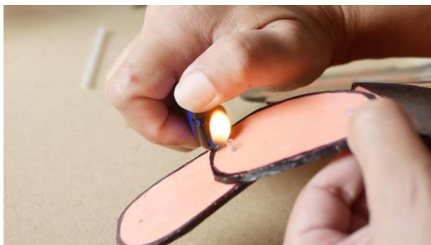
Gambar 21 : Panaskan bagian ujungnya dengan api hingga agak lembek, lalu ditekan dengan permukaan sisi gunting agar melebar
