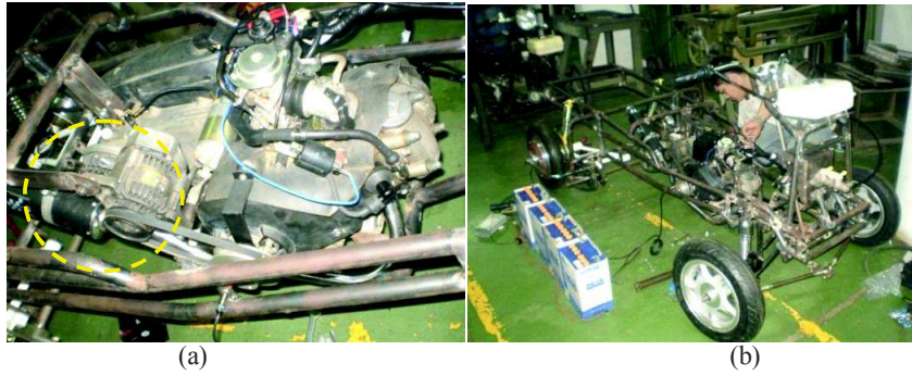
Gambar 10. Mesinskutik yang telah dilengkapi alternator tambahan (a), persiapan saat akan dilakukan uji kinerja statik (b).
