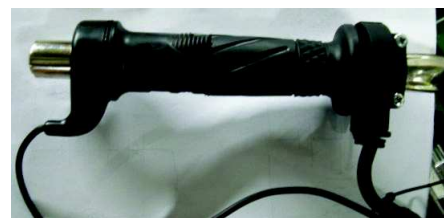
Gambar 6. Gabungan handel akselerasi untuk motor listrik (kiri) dan motor bakar (kanan)
