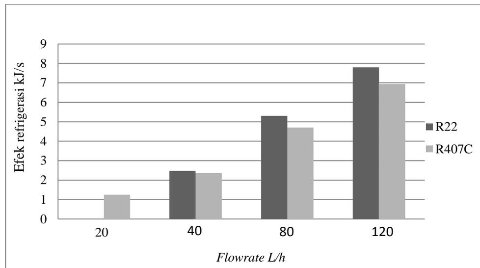
Gambar 4. Perbandingan efek refrigerasi dengan *flowrate*.
