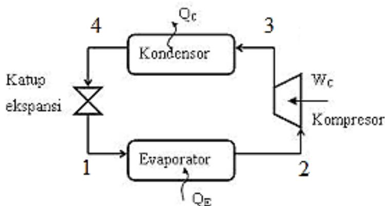
Gambar 1. Komponen mesin pendingin.
