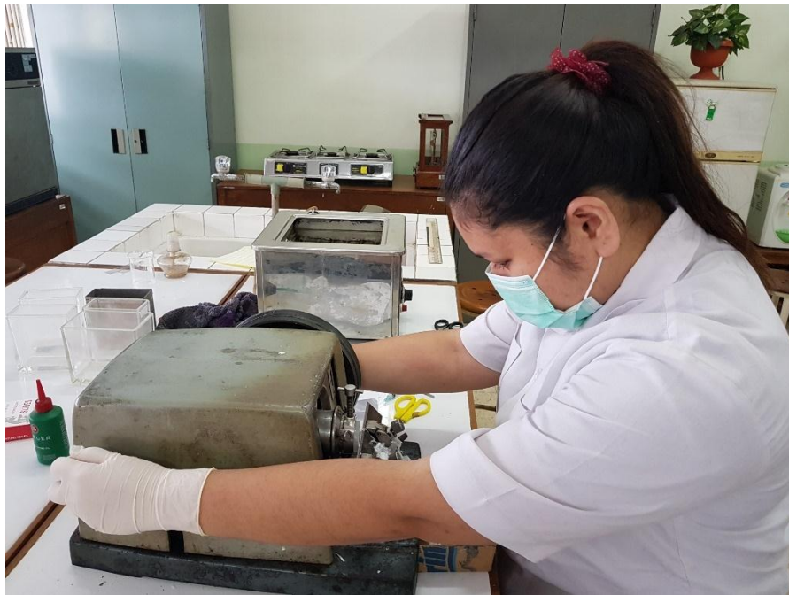
Proses pemotongan organ hingga tipis menggunakan mikrotom putar
