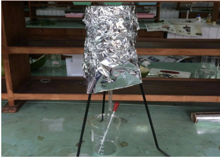
Dilakukan teknik maserasi untuk mengubah simplisia menjadi ekstrak
