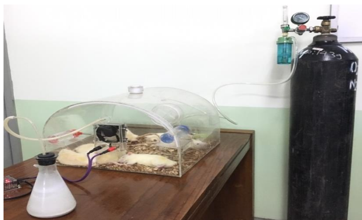
Tabung gas, Chamber dan Sodalime
