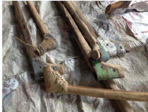
**Gambar 4. Perbandingan Tangkai Pethel yang Terbuat dari Metal dan Kulit Kerbau.**
