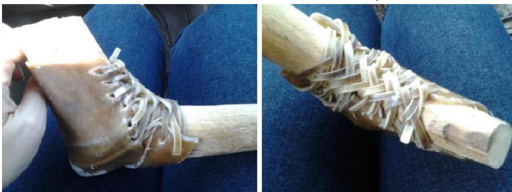
**Gambar 5. Detail Tangkai Pethel yang Terbuat dari Kulit Kerbau.**
