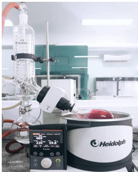
Proses evaporasi dari hasil maserasi buah cranberry hingga terbentuk pasta
