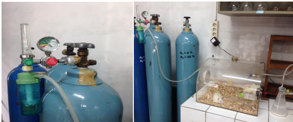
Gambar 5. Gas O 2 sebesar 8% untuk perlakuan hipoksia dalam chamber
