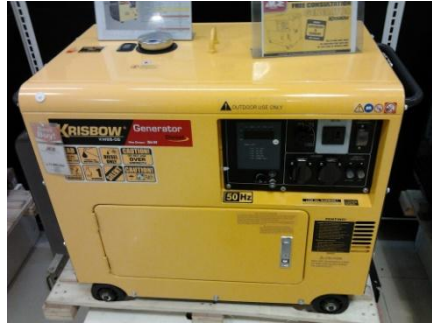
■ Gambar 2. Generator Set Berbahan Bakar Solar tanpa Fasilitas ATS
