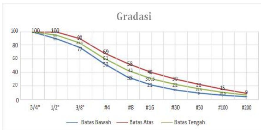
Gambar 2. Grafik Gradasi Agregat dalam Campuran
