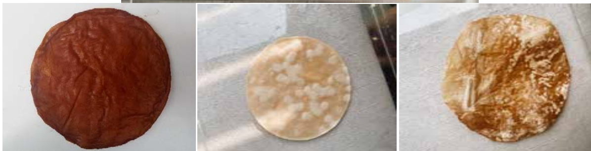
Gambar 6. Percobaan Memproduksi Sampel Material dari Fermentasi Teh Kombucha; kiri ke kanan: Fermentasi Teh Hitam, Teh Putih dan Teh Hijau
