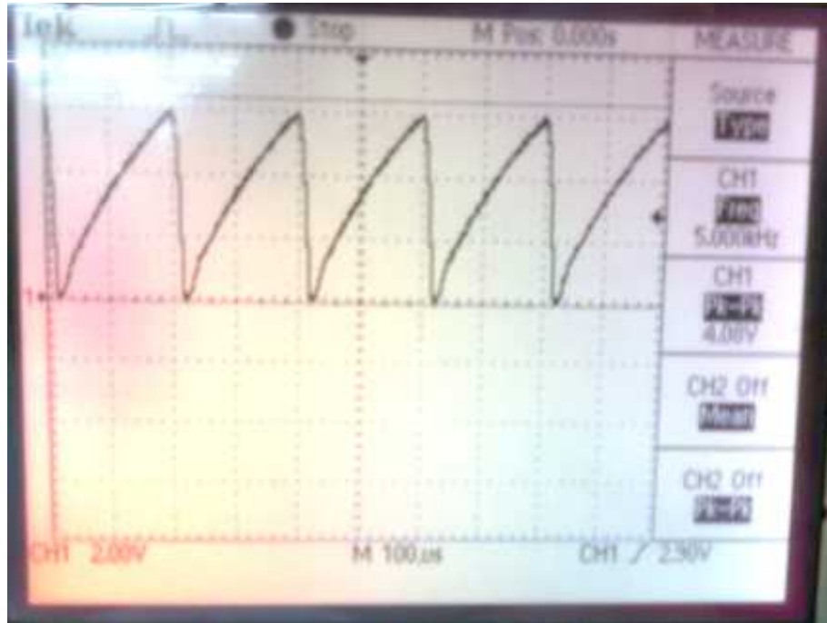
Gambar 12. Hasil Penguatan Sinyal Modul Microphone Amplifier
