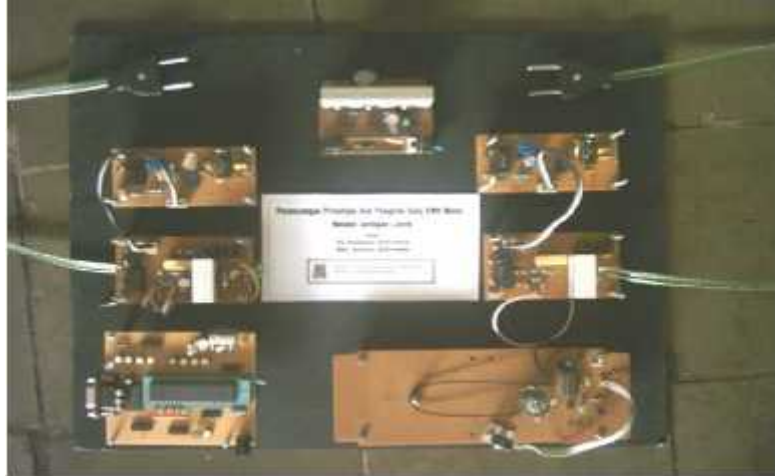
Gambar 3. Alat Pengirim Data KWH Meter Menggunakan Jala-Jala Listrik [4].
