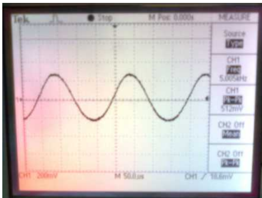
Gambar 13. Hasil Penguatan Sinyal Modul Audio Amplifier
