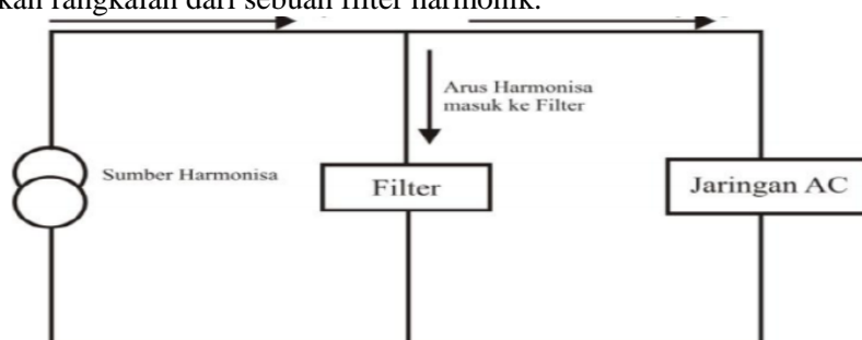
■ Gambar 4. Rangkaian filter harmonik
