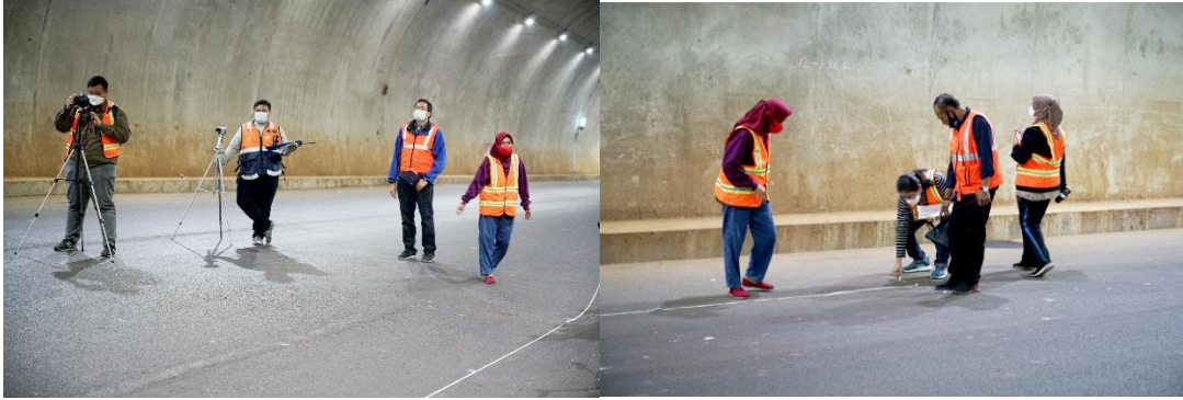
Gambar 5. Kegiatan pengambilan data pencahayaan terowongan Cisumdawu malam hari. (Sumber: Dokumen Pribadi 2021).
