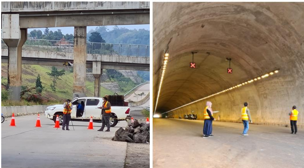
Gambar 4. Kegiatan pengambilan data pencahayaan terowongan Cisumdawu pada siang hari. (Sumber: Dokumen Pribadi 2021).
