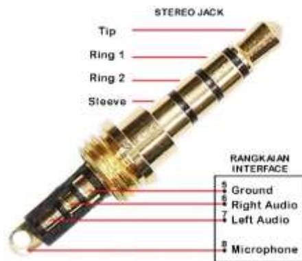
Gambar 7. Koneksi Stereo Jack dan Rangkaian Interface
