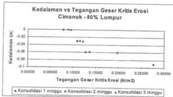
Gambar 4 Kedalaman vs tegangan geser kritis erosi pada sedimen campuran 80% lumpur + 20% pasir
