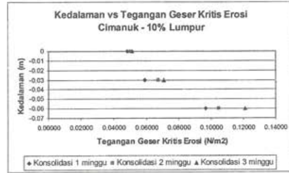
Gambar 14 Kedalaman vs tegangan geser kritis erosi pada sedimen campuran 10% lumpur + 90% pasir
