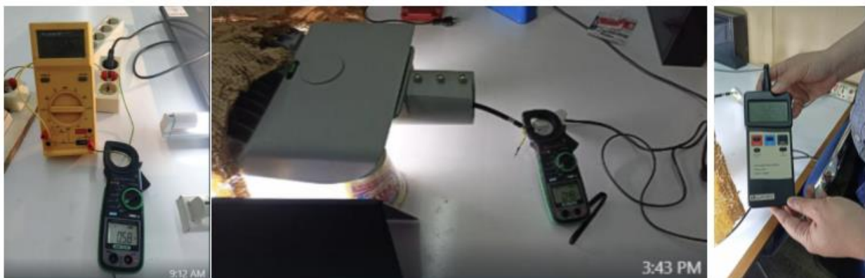
Gambar 8. Data suhu, kelembapan, arus dan tegangan dilakukan kalibrasi dengan alat ukur terkalibrasi
