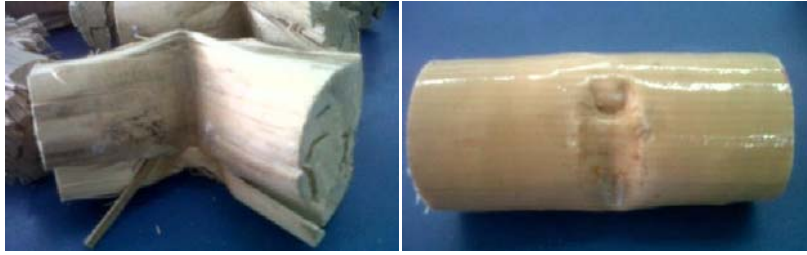
a. bentuk kerusakan impact rotan tanpa laminasi
