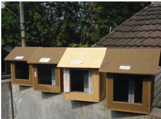
Foto 2. Maket dengan model rumah yang memiliki jendela kaca diletakkan di ruang terbuka menghadap timur, disinari sinar matahari, siap dipakai untuk pengambilan data suhu yang tertera pada thermometer air raksa pada setiap jamnya dari pukul 09.00 sampai pukul 16.00, selama 40 hari.
