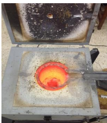
Gambar 4. Proses pengecoran dengan marple furnace
