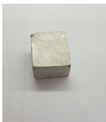
Gambar 5. Paduan Solder Sn-0,7Cu-“x”Zn setelah dilebur
